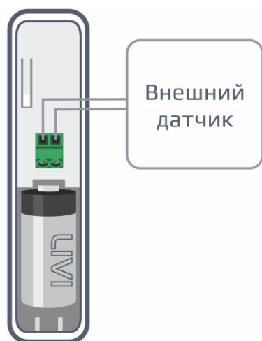
Рисунок 8.1 — Схема подключения внешнего проводного геркона/ШС
